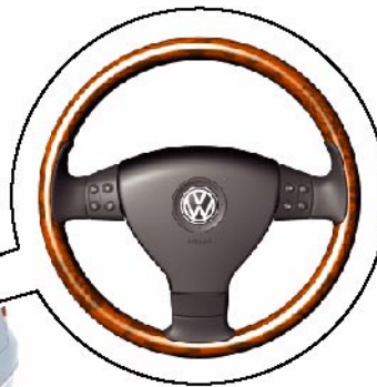
Steuergerät für Multifunktionslenkrad J453, im Lenkrad
