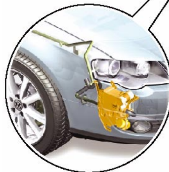
Steuergerät für Zusatzheizung J364, im Radkasten rechts
