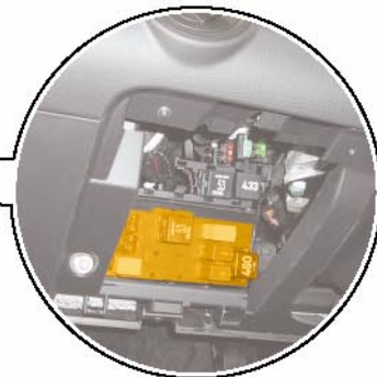
Relaisträger am Steuergerät für Bordnetz, unter der Schalttafel links
